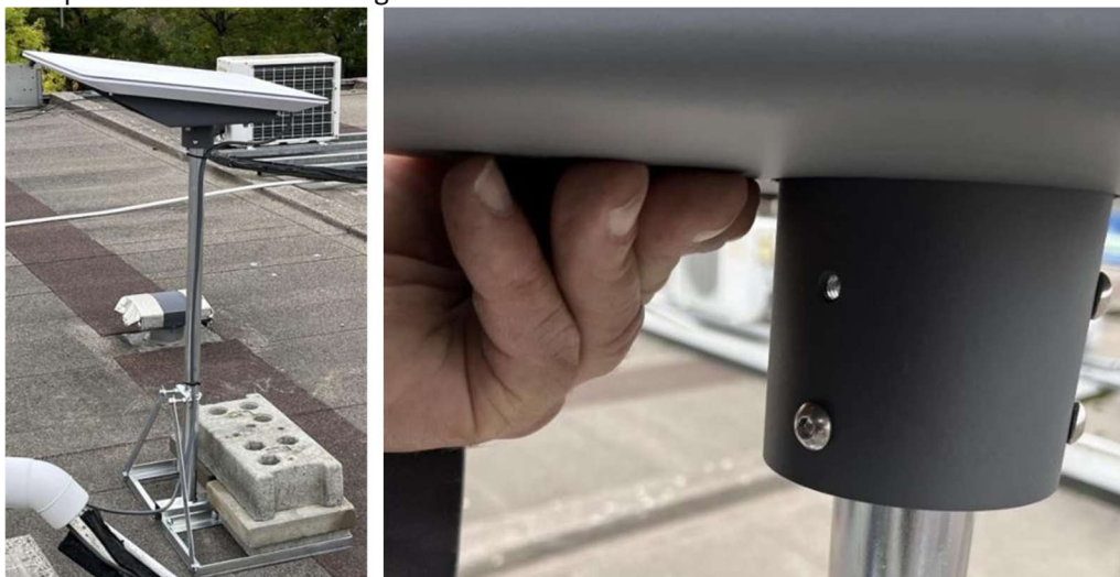
Options de montage pour Enterprise (montage mural, montage pivotant et adaptateur de mât)
