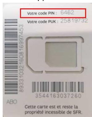
**Préco** : Au moment d'entrer le code PIN, garder cochée l'option de désactivation de la vérification du code PIN pour ne pas avoir à le saisir à chaque nouvelle connexion du routeur sur le réseau mobile (suite arrêt électrique/power off).
