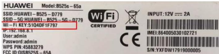
Il existe également une fonction WPS (bouton sur le dessus du routeur) pour appairer un appareil compatible WPS sans avoir à entrer la Clé WIFI
