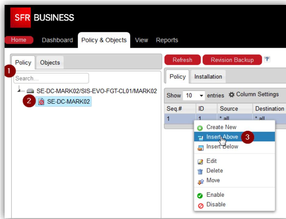
On sélectionne les conditions de notre règle, en utilisant les objets préalablement créés et on choisit une action « Accept » pour que le flux soit autorisé.
