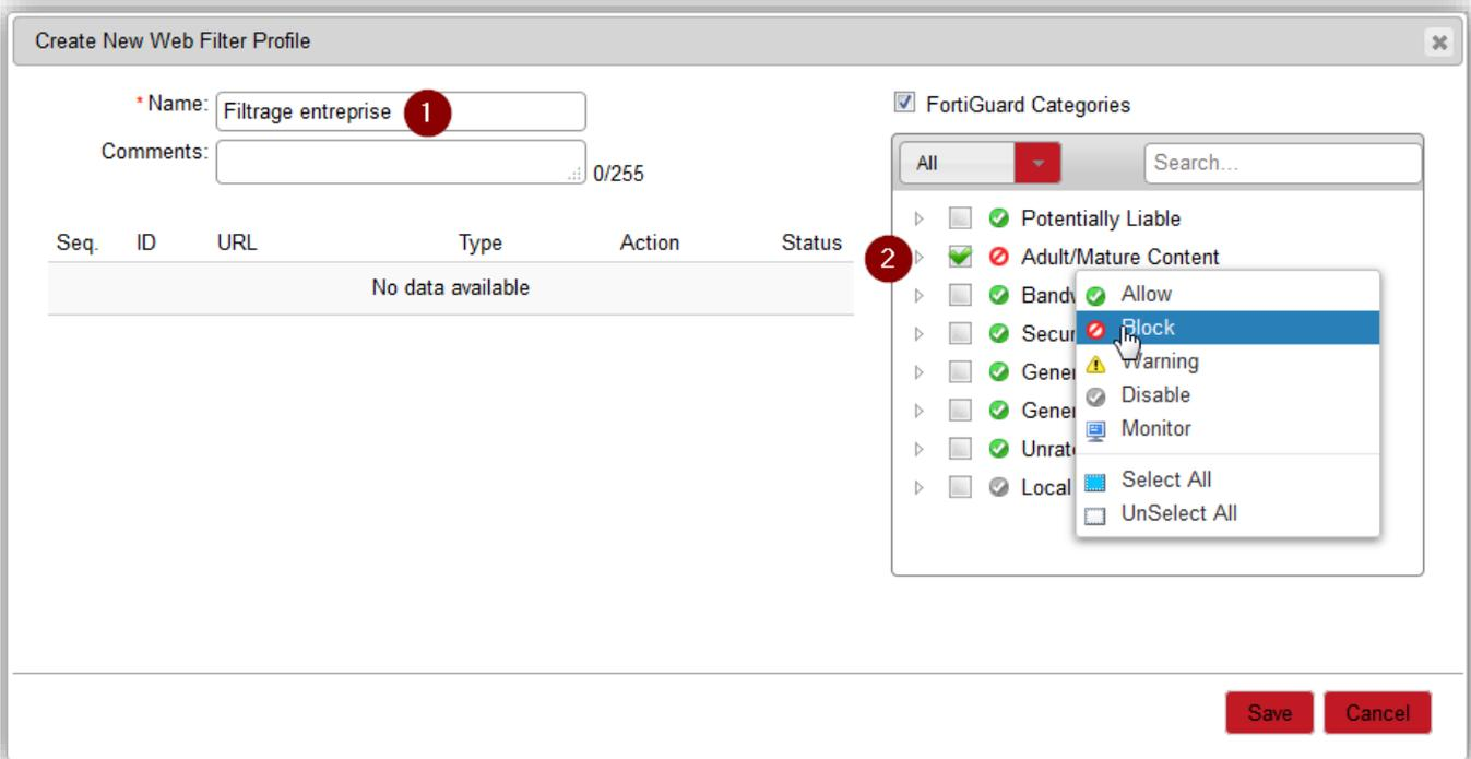
Pour bloquer les sites de « Hacking », il s’agit d’une sous-partie de la métacatégorie « **Potentially Liable** ». On déroule la catégorie pour laisser apparaître les « sous catégories », dont « **Hacking** ». Cocher « **Hacking** », puis faire un clic droit puis « **Block** ». Valider notre profil par « **Save** »
